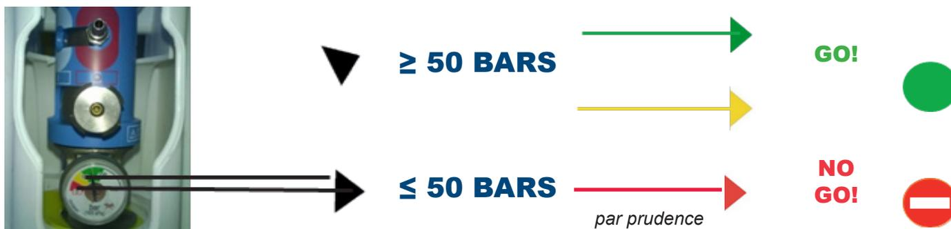
! Avant toute utilisation vérifier que la pression du manomètre est impérativement supérieure à 50 bars. Sinon, changer de bouteille. Ventiler un enfant avec une bouteille vide est à risque vital !
